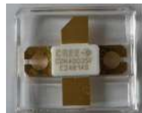
図2 終段に使用した GaN デバイス (CGH40035F)
