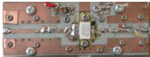
図10 1号機ドライブアンプ(CG40035F)
