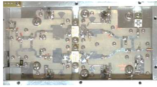
図16 2号機完成図(終段部:JA8CMY設計製作基板を使用)
