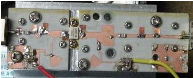
図16 2号機完成図(終段部:JA8CMY設計製作基板を使用)
