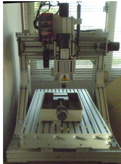
加工に使った CNC フライス盤
